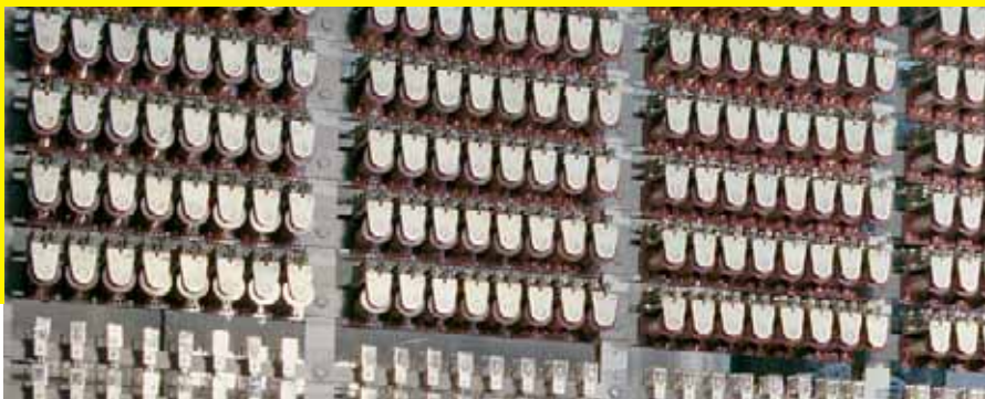
Rekonstruktion der ersten programmgesteuerte Rechenanlage »ZUSE Z3«, 1941
